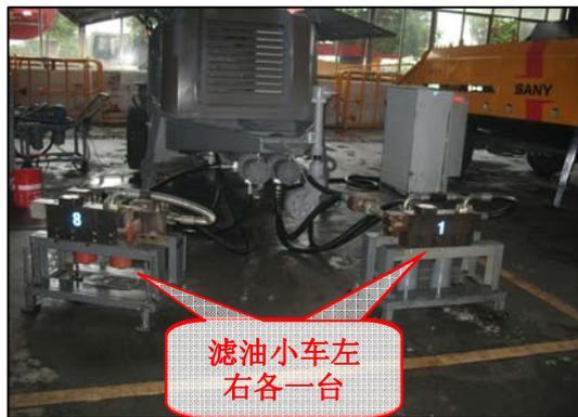
图 1-26 滤油小车接入液压系统
