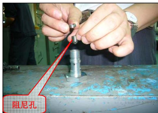
图 2-4 阻尼孔堵塞
