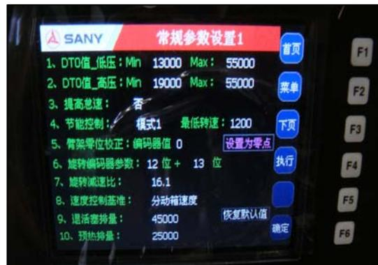
图 4-6 设置零点图示
