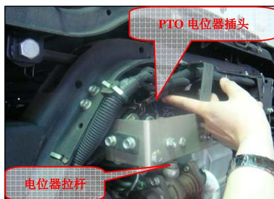
图 4-12 PTO 电位器插头
