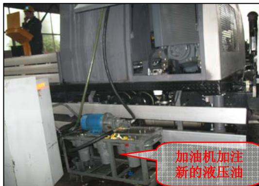
图 1-27 用加油机加注新液压油
