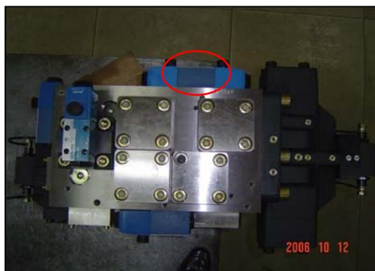
图 1-18 取消溢流阀图示
