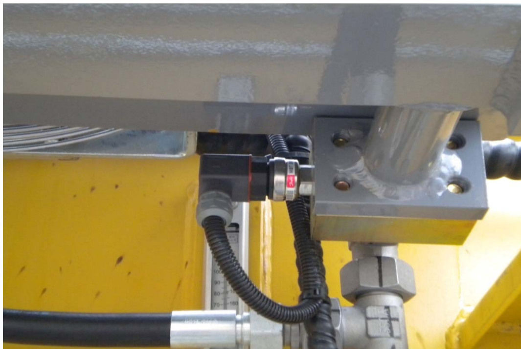
装在液压油散热器进油口处的温度传感器(型号：084Z4030)
