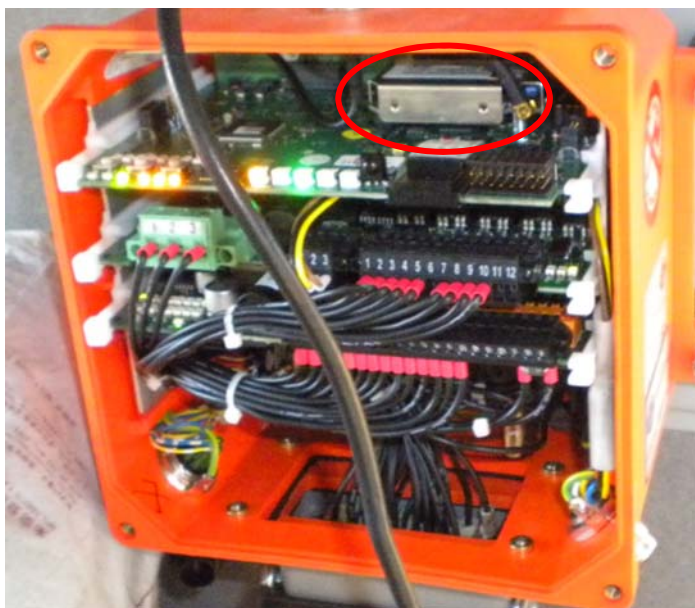
高频发射模块在第一个电路板上
