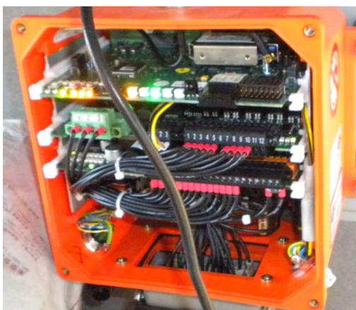
接收器第三个电路板为比例放大板
