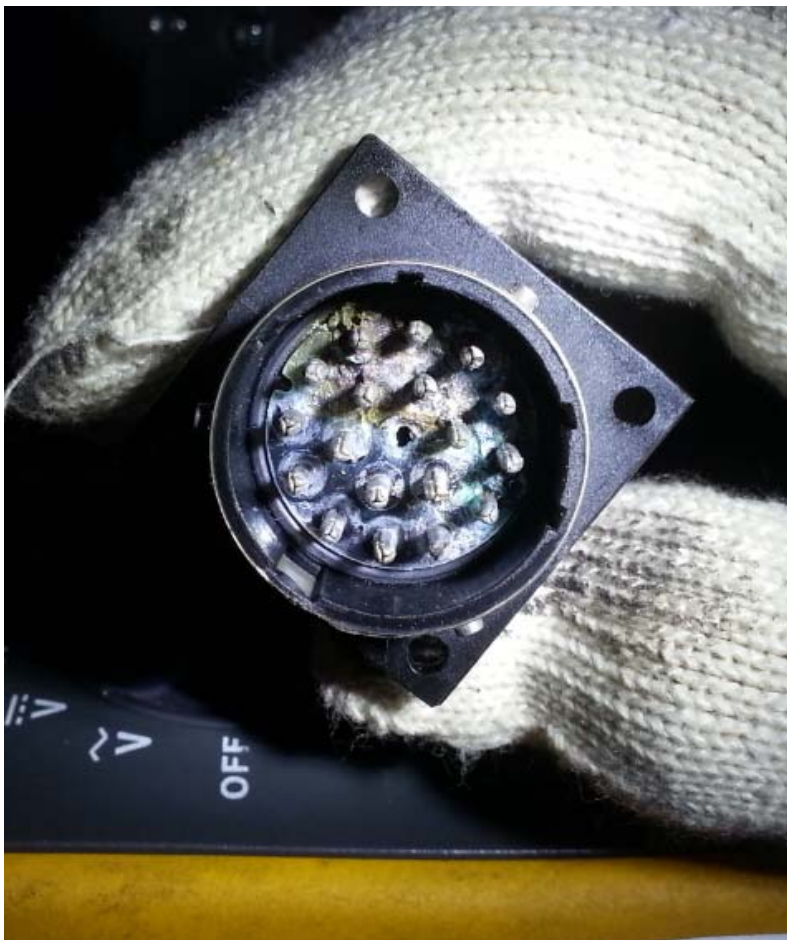
被锈蚀的线束5电器箱后方插接件
