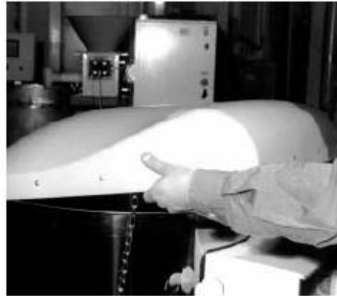
g) 将盖子放置在过滤器壳体上，确保后部挂钩（盖子内）和壳体上部边缘连接。（如图所示）
