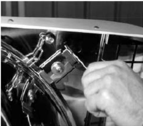
d) 在过滤器壳体的边缘下方放置好挂钩后用套筒扳手拧紧安全螺母（尺寸 10）。
