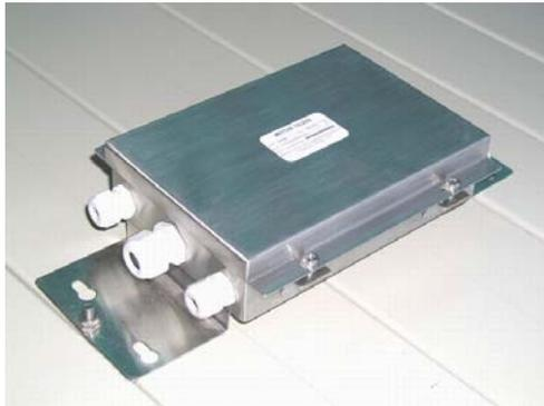
**检查方法：**五孔接线盒在使用过程中，由于下雨或清洗等原因进水，使其绝缘下降，造成称重仪表读数漂移等故障，如果经过烘干处理后仍不能恢复正常则须更换五孔接线盒。
