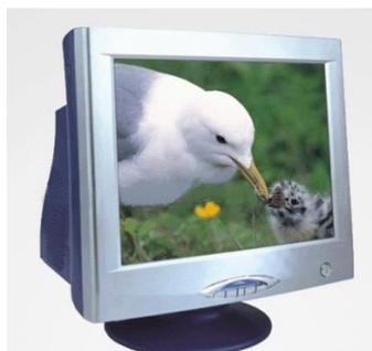
检查方法：搅拌站控制系统显示器出现黑屏、水平亮线、垂直亮线、偏色等故障时，在排除了是显卡故障和显卡接触不良的情况下，须更换显示器。
