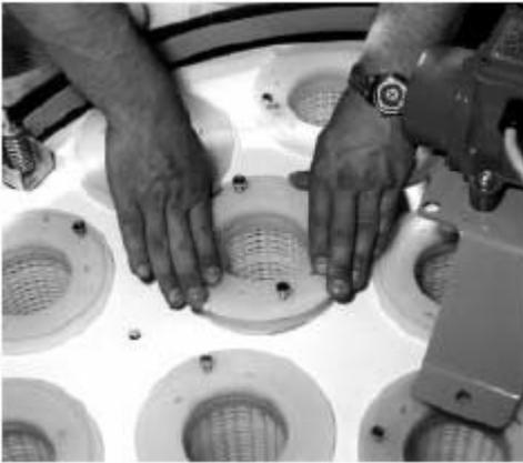
b) 在滤芯的顶部边缘涂油脂，使其易于装进板上的孔位。（采用硅基润滑脂）
