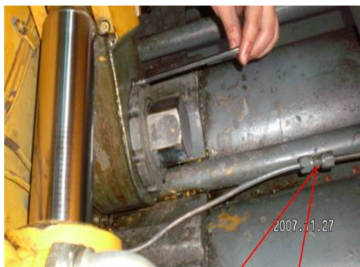
料斗上递进式分配阀 的进油润滑脂管接头
