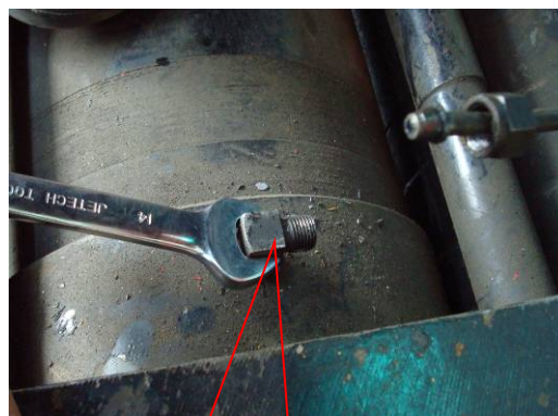
输送缸上润滑缸活塞 的润滑脂管及接头
