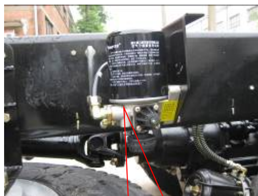
干燥器过滤水份效 果差是四回路阀结 冰的根源问题
