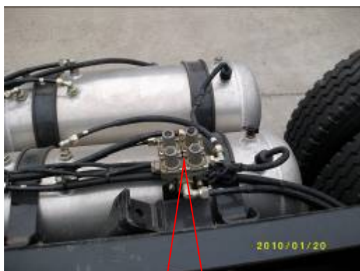
应急可以用热 水烫该阀解冻
