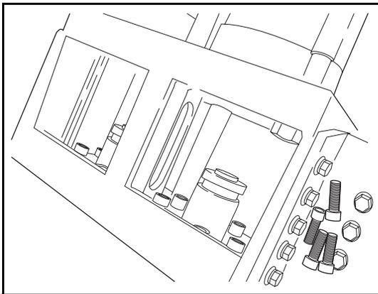
图 3-2(3) 拆掉水箱与主油缸的紧固螺栓
