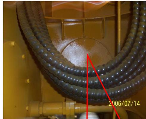
清洗口 3 在驾驶室后方的转塔内，此口必须打开清洗！
