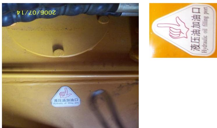
1. 液压系统加满矿物质的液压油(HLP46#)或以合成酯为基础的生物降解液压油(HLP-E46#)或不易燃液压油(HFC46).泵车出厂时采用美孚或壳牌46#液压油（约 700 升）。
