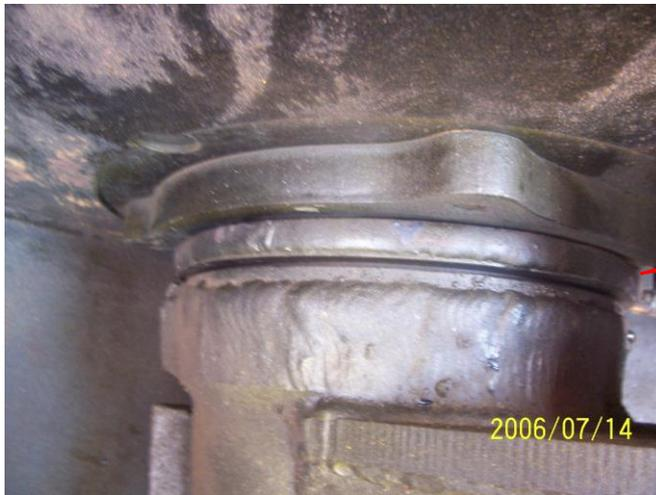
切割环此处及其对面是最先磨损，发现磨损时请将切割环掉转 90
