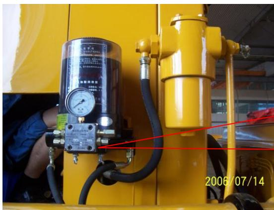
往里面加注锂基脂时千万保持干净。锂基脂必须保持良好的流动性，即流下时成线状，如流下的状态成凝固或半凝固块状则锂基脂不合格
