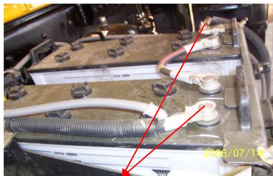
为防止拆线时正极线搭铁打火，请先拆正极，后拆负极，安装时顺序相反
