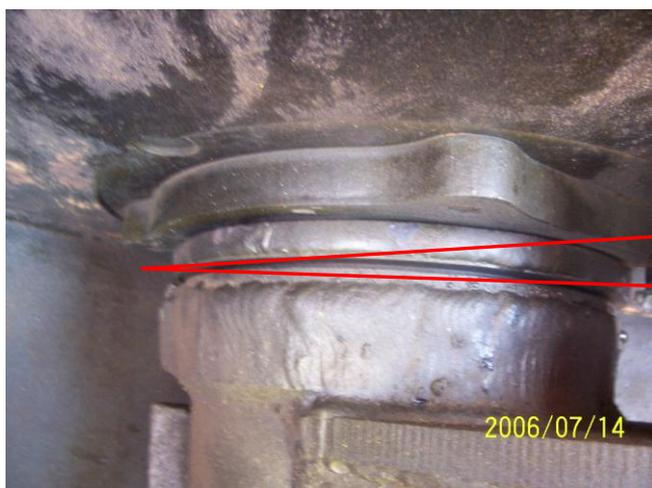
料斗此处积结混凝土极易造成 S 管下部磨损，请及时清除积料!!!
