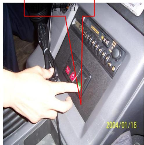
C 踩下离合器，将底盘置于空档，从油泵位置切换到行驶位置后关掉电源。
