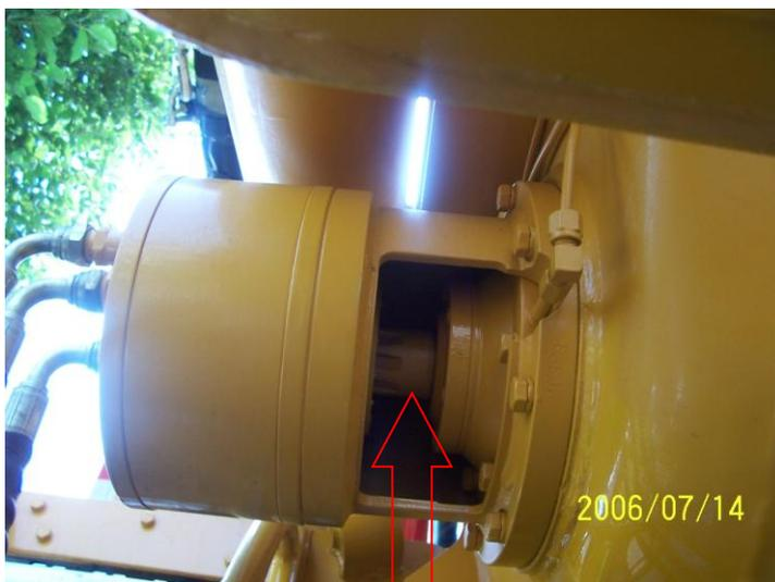
如此轴上有油泥或混凝土浆漏出，立刻停机检修，防止污染液压系统。
