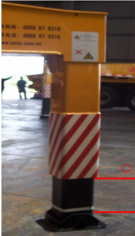
注意：支腿支撑（收拢）时，必须分两次支撑（收拢）到位，第一次撑出距离约 30 厘米。支承地面基础必须牢固，确保地层不下陷，并时刻检查。
