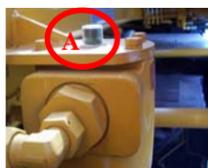
13. 注意补油。在正常运行后, 观察液压油位是否在规定的规定位置内, 否则应补充到最低油位标准刻度线;
