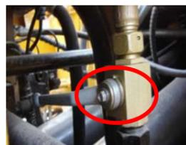
**注意:** 对泵车进行任何修理之前都必须打开此球阀进行卸压, 否则有可能引起安全事故的发生!
