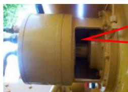
如此轴上有混凝土浆，施工完毕后，应立即更换搅拌轴套及密封。
