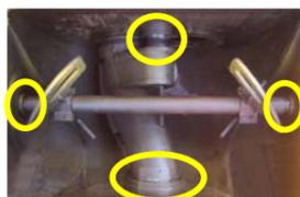
**注意：**每次混凝土泵送完毕，**空泵**至四个润滑点流出干净的润滑油。
