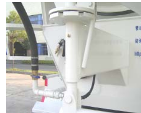
卸料槽转动部位
