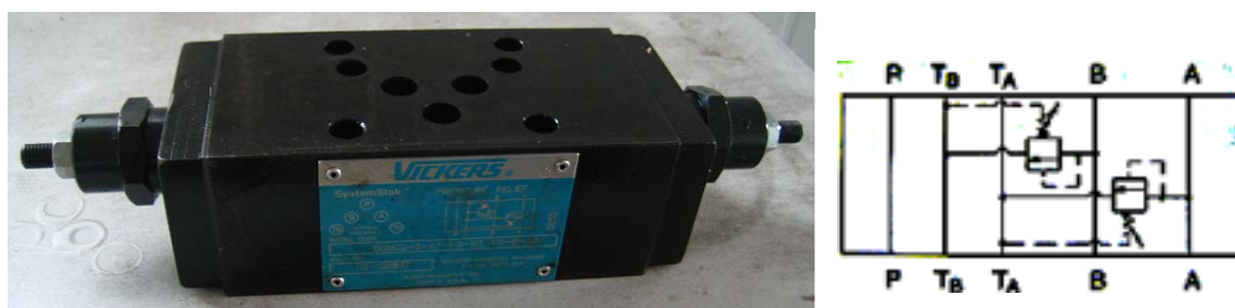
图 37 叠加溢流阀及功能符号
