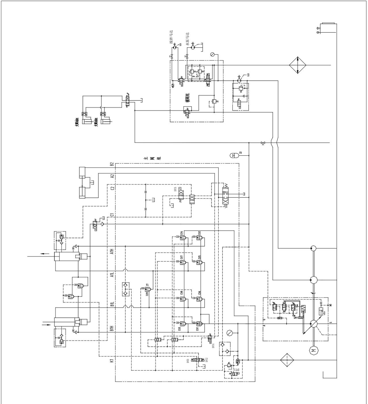
图7-1 主系统液压原理图
