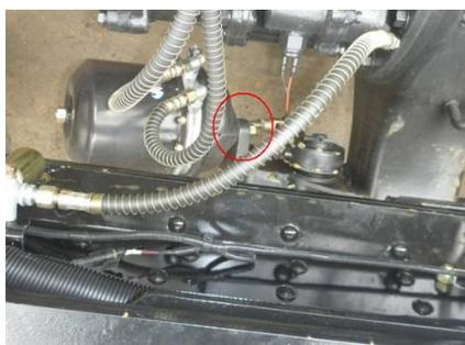
b、将铆钉孔内及周围杂物清理干净，采用 M14 高强度螺栓代替铆钉重新连接下垫板、尾横梁及后横梁，涂螺纹锁固胶，扭矩（175~190）N·m；
