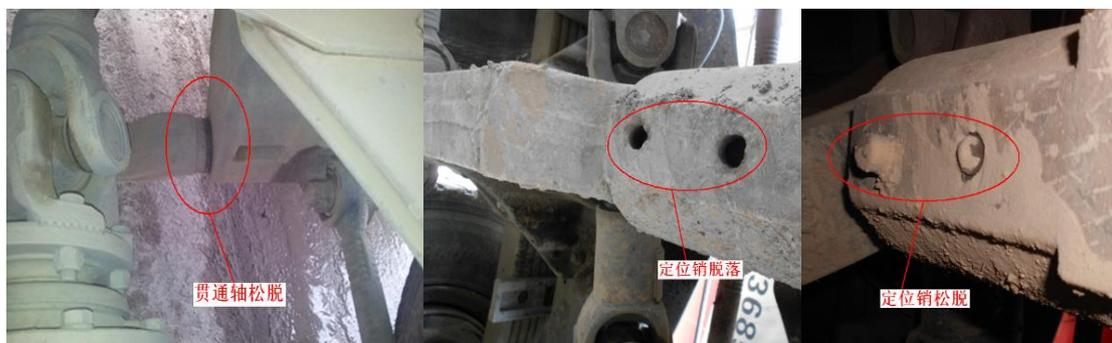
图1 贯通轴和贯通轴销异常区域，该区域需服务工程师重点检查
