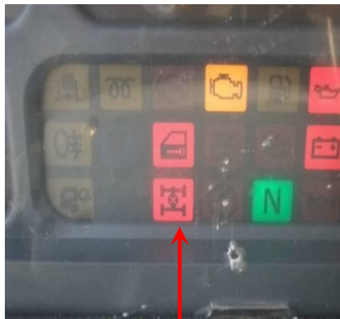
2、当打开轴间差速锁后,仪表相应图标显示,并有蜂鸣器的响声。
