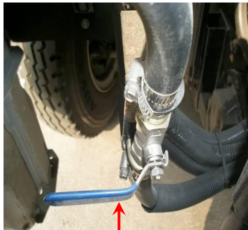
暖风进水管球阀开关，此时处于关闭状态。
