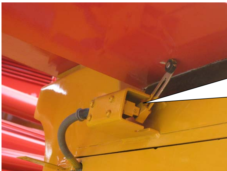
3.4.11 电比例阀，行驶泵送位置切换开关线路安装
