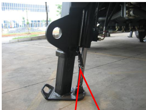
支腿支承在坚实的地面上并插好四个支腿插销
