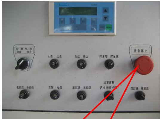
紧急停止按钮按下后必须旋转按钮才能解除
