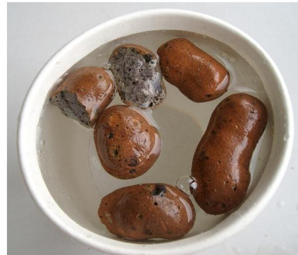
当陶粒在大气压时，由于有很多的毛细孔，内有气阻而水不得进入，但在缸中高压下工作时，水被强行压入毛细孔中（水泥和砂直径大而不能进入），使砣失水而变得干硬
