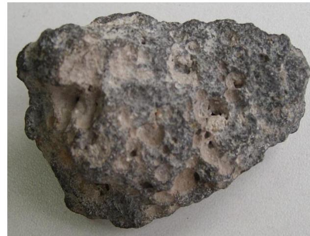
当在大气压中时，由于有气阻水泥混合物不会进入孔中，但当在缸中泵送时由于压力大而吸收砂浆堵管
