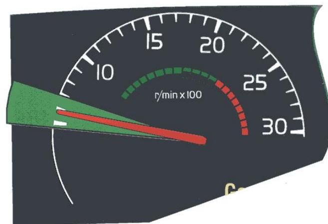
停车后，待发动机怠速运转2-3分钟后熄火，熄火前绝不允许猛哄油门。
