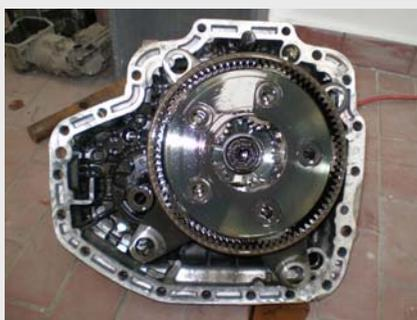
**错误操作：**长期空档滑行，使变速箱油泵处于怠速状态下，无法提供足够油压。
