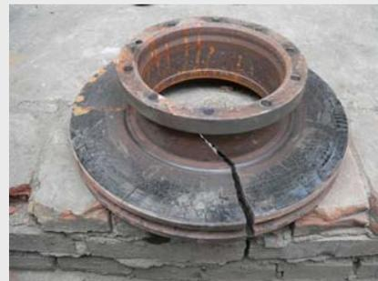
**错误操作：**不正确地使用刹车系统，导致刹车盘或刹车鼓过热开裂。
