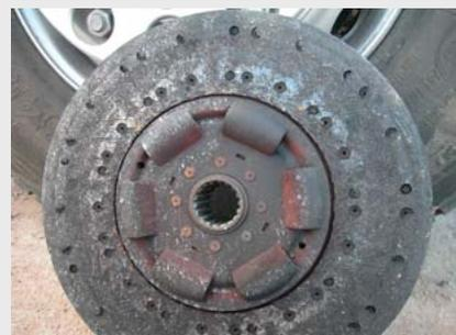
**错误操作：**长期违规操作离合器，如起步时轰油门、捂车后强行油离配合起步、离合器半联动操作、两脚离合操作等。
