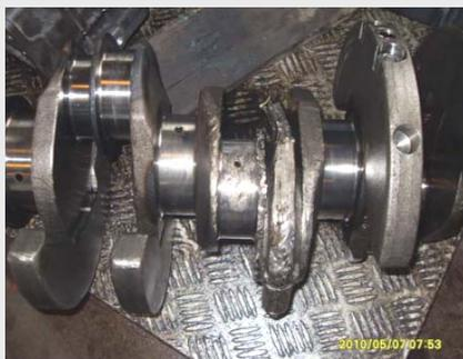
**错误操作：**高速行驶时强行减档，造成发动机超速。
