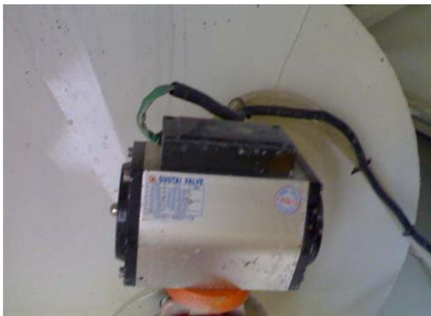
9、切换到手动，打开所有称量斗的气动蝶阀及斗阀门，放空称量斗内的残料。
