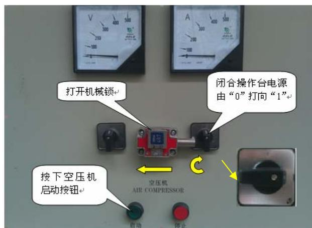
3、调整空压机的压差，压差调节为 0.2Mpa，最低气压调为 0.5Mpa，最高气压调为 0.7Mpa，气压大于 0.4Mpa 方可启动搅拌主机。
