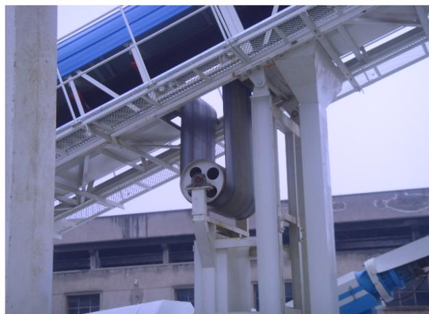
6、滚筒调整方法，斜皮带及平皮带张紧滚筒调整。
