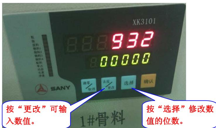
11、若数字输入完毕，检查砝码加载的重量与仪表的数字是否一致。称量斗上不得有异物，操作人员不得碰称量斗。待称量斗平稳时（无晃动），待上行数字停止跳动后再按“确认”。
