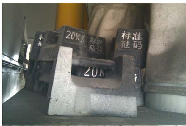
10、砝码加载完毕后按“确认”键，此时仪表下行文本框出现“000000”，输入加载砝码的重量值。
