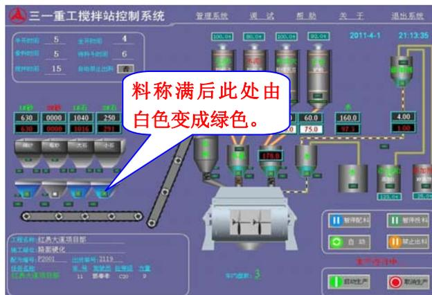
15、当最后一种骨料卸完至平皮带并超过骨料时间的设定时间，此时待料斗会显示有料。
