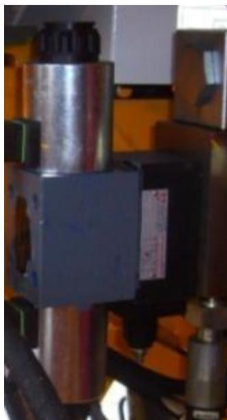
叠加式溢流阀（直动式）：用于辅助油路中，如搅拌、冷却、清洗等油路，安全保护作用。
