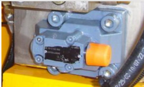
板式溢流阀（先导式）：用于主泵送油路及分配油路中，安全保护作用。
