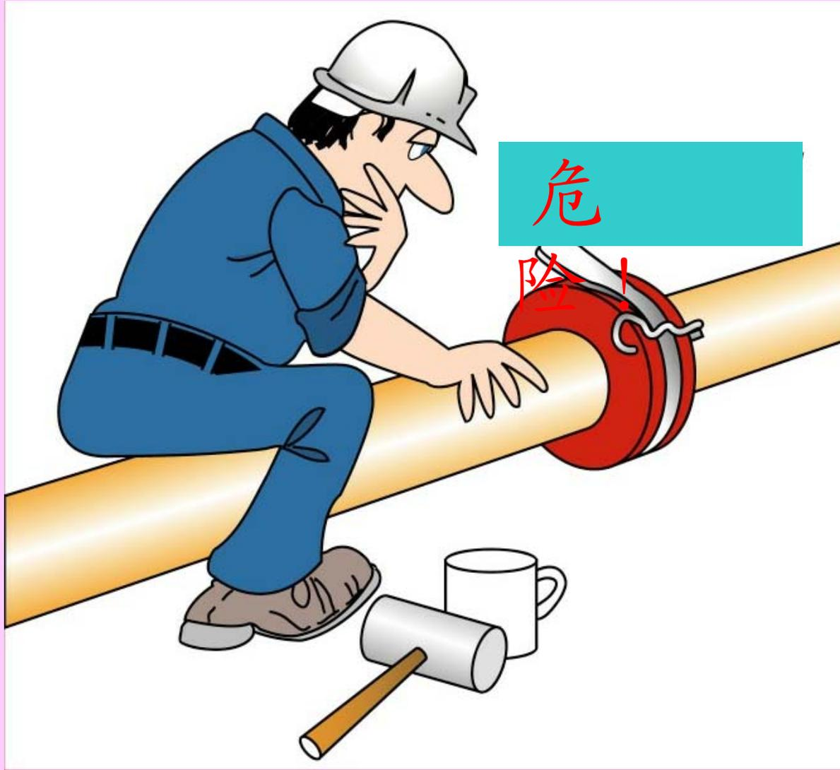
泵车在工作时，千万不要站在输送管上、或坐跨在输送管上
