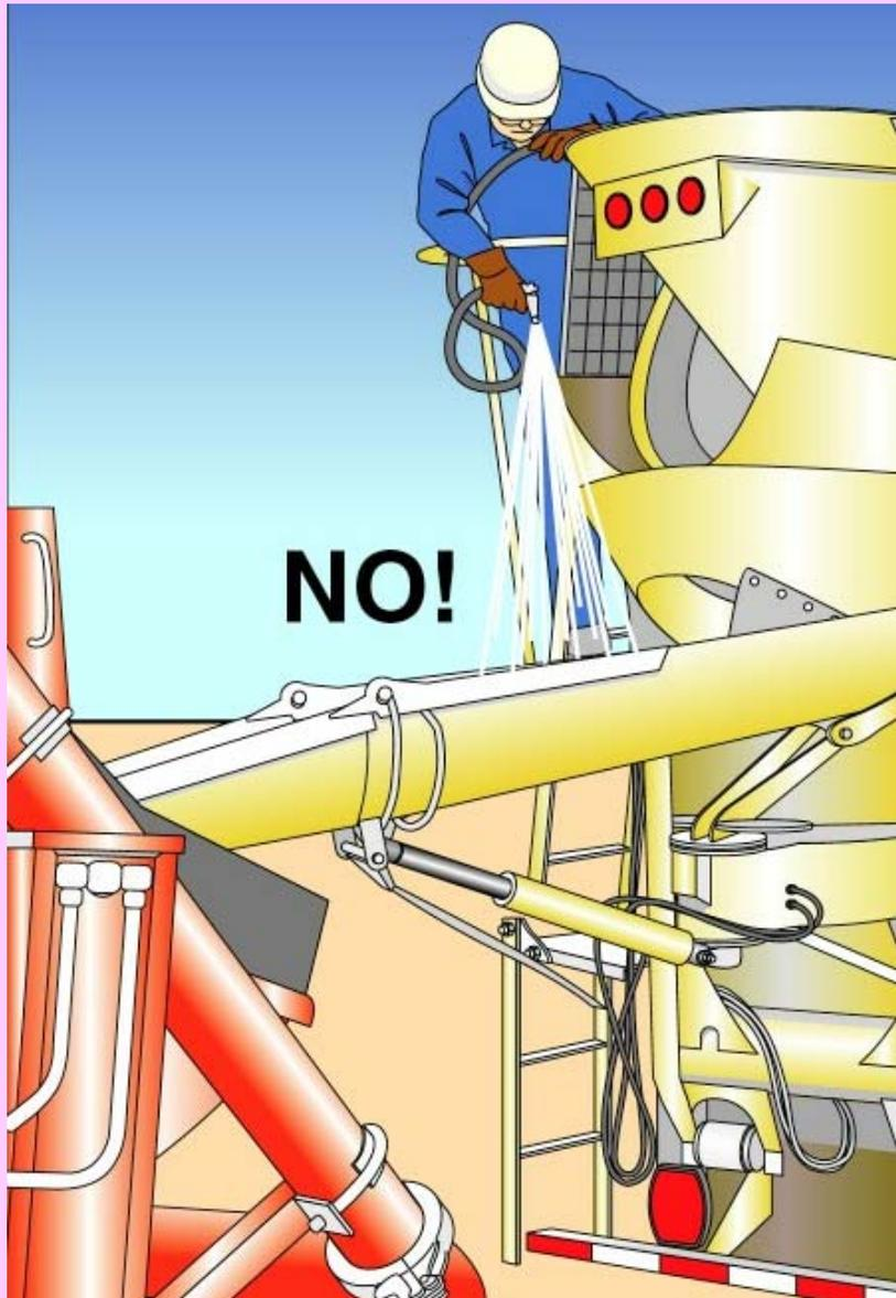
在泵车操作工准备好之前，搅拌车司机不能将料卸入料斗。
