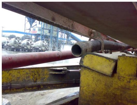
利用外来动力洗臂架管的混凝土。
