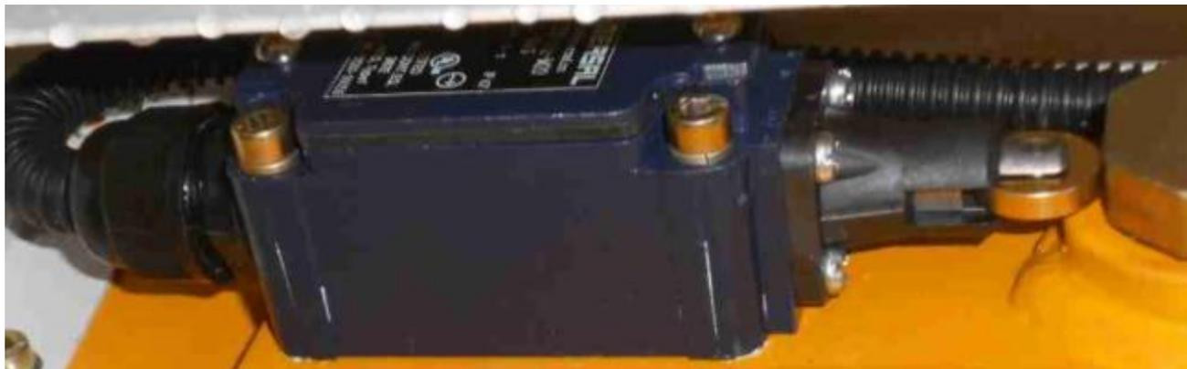
打开料斗筛网，栅栏开关将信号送入控制器，通过程序控制拖泵停机，用于泵送时误操作的保护。
