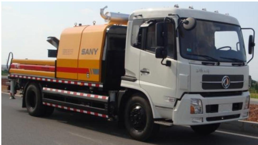
车载泵是车载式混凝土输送泵的简称，是一种将用于泵送混凝土的泵送机构安装在汽车底盘上的混凝土泵送设备，所以车载泵具有行驶功能和泵送混凝土的功能。
